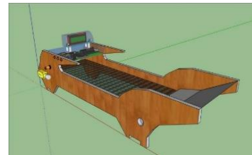
Gambar 2. Desain Alat Penghitung Kelapa Sumber: (Data Penelitian, 2020)
