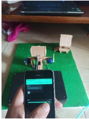
Gambar 8. Menggerakkan motor servo dengan aplikasi blynk
