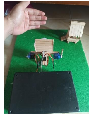
Gambar 7. Menggerakkan motor servo dengan sensor PIR
