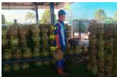
Gambar 4. Aktivitas Pengangkatan Tabung Gas Elpiji 3 Kg dari Conveyor (Sumber : Data penelitian, 2021)
